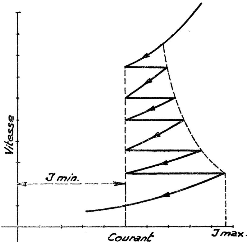
Fig. 5. — Mode spécial de récupération à échelons de vitesse constants pour moteur série à courant continu, à tension constante.
