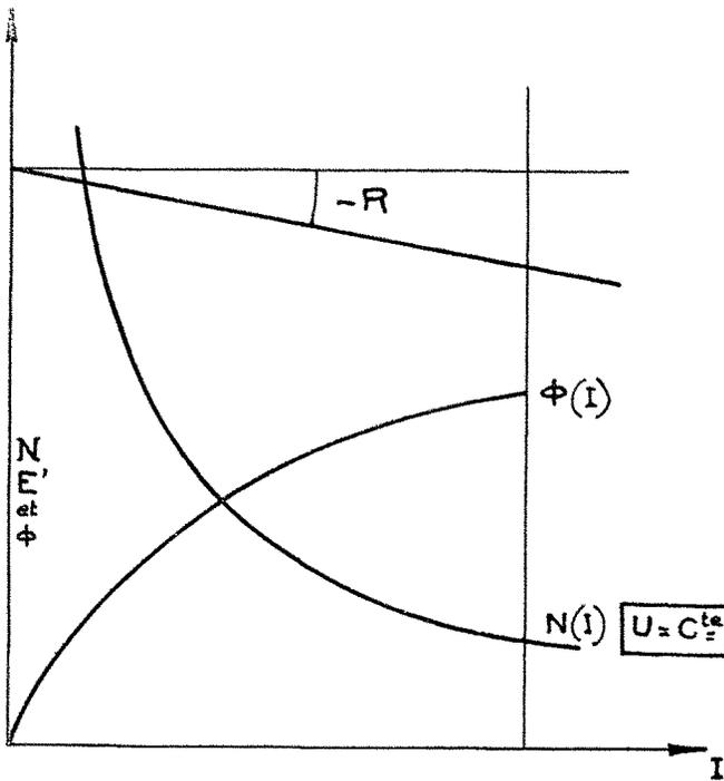
Fig. 2. — Caractéristiques de vitesse et de flux d'un moteur série de traction marchant à tension constante.
