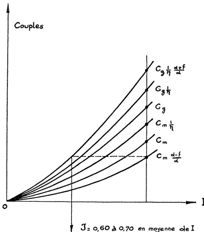
Fig. 1. — Couples divers en fonction des courants absorbés (les courbes de couples sont arrêtées avant que la saturation soit atteinte).
