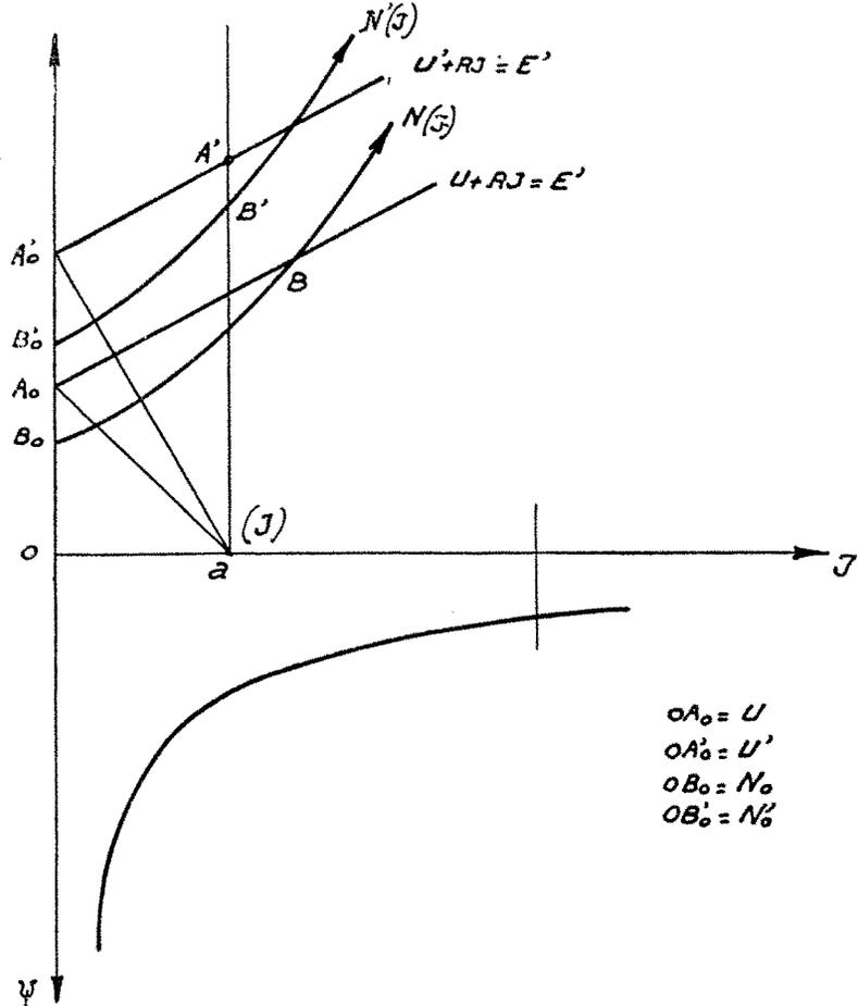
Fig. 3. — Caractéristiques de récupération d'un moteur série pour diverses valeurs de la tension du réseau.
