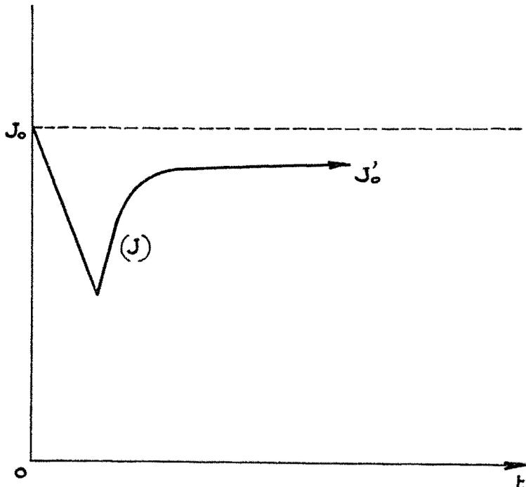
Fig. 6. — Forme théorique des variations du courant d'armature d'un moteur série travaillant en récupération lors d'une variation de régime.
