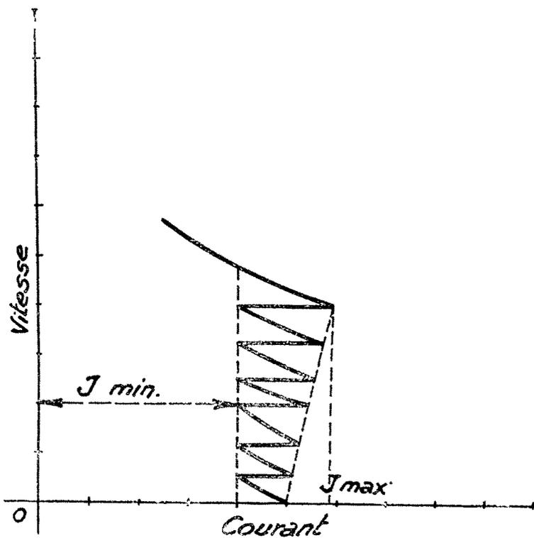
Fig. 4. — Mode spécial de démarrage avec échelons de vitesse constants pour moteur série à courant continu sous tension constante.
