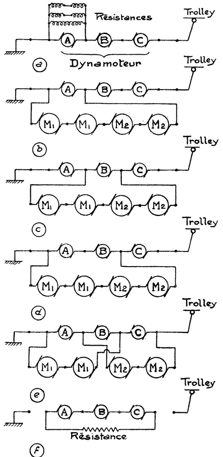
Fig. 8. — Procédé de démarrage et de freinage par récupération (système Somaïni)
