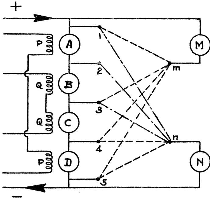
Fig. 7. — Procédé de démarrage et de freinage par récupération (système Della Riccia).
