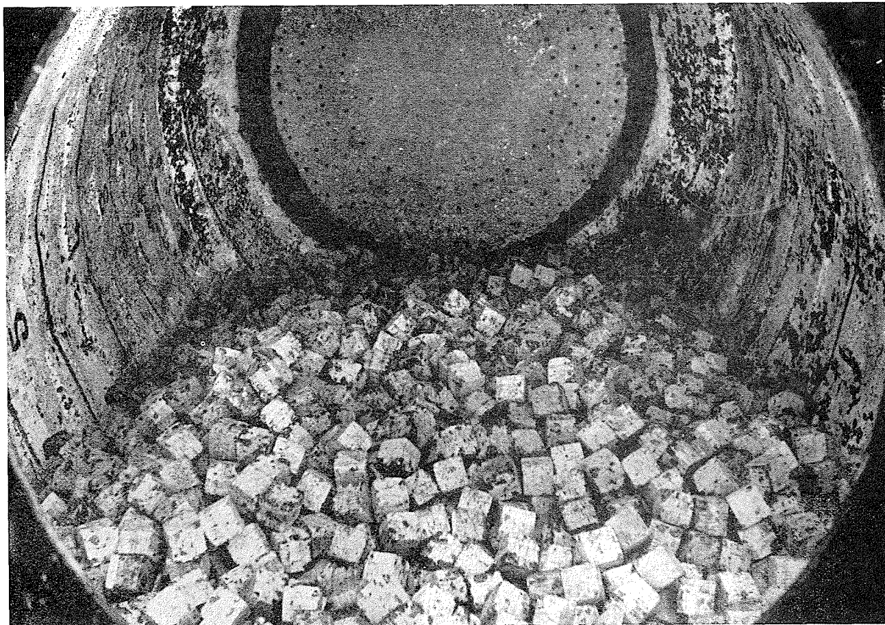
PHOTO N° 3. — VUE INTÉRIEURE DU CONVERTISSEUR RABATTU. On aperçoit le liège schématisant la chaux et un fond spécial dépourvu de tuyère au centre.
